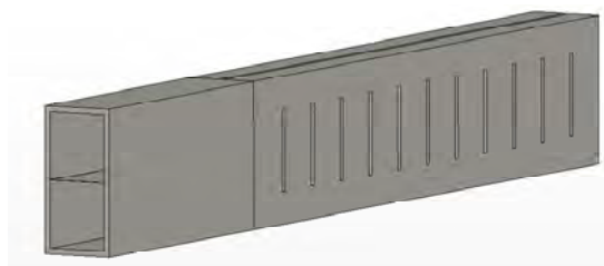
Fig.2 Structure of the mode filter 图 2 模式滤波器结构
